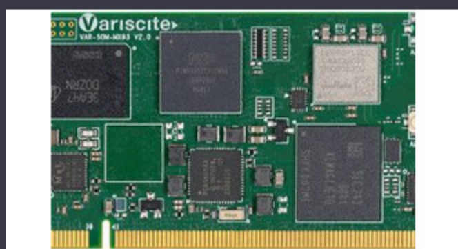
Mkono wamakompyuta-module ali ndi purosera ya 1GHz
